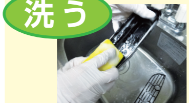
カップトレイ受けを上 に引くとはずれ ます。溜まった水 を捨て洗浄します。
